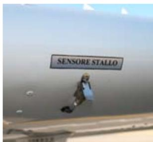
**Tutti i velivoli sono dotati di serie di un sistema di avviso acustico di stallo**
